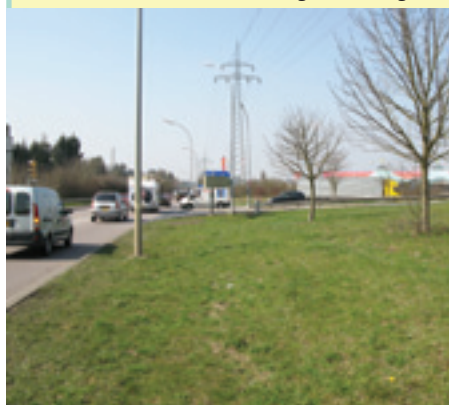
Fauchage au niveau d'un carrefour. Pour assurer la visibilité, il n'est pas nécessaire d'aménager les zones de visibilité en gazon artificiel, mais elles ne devraient pas non plus être couvertes de hautes herbes. La prairie à herbes courtes constitue un compromis qui permet d'atteindre simultanément les objectifs de la sécurité routière et de la valorisation environnementale.
