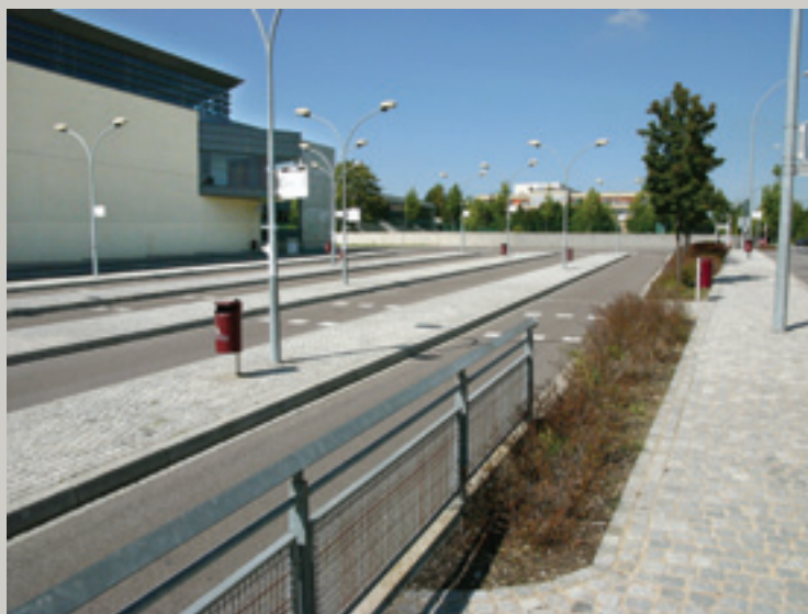
Exemple négatif: Arrêts de bus aménagés de manière conventionnelle. Critiques: pavés posés dans le mortier, plates-bandes avec végétation non indigène, épandage d'herbicides sur les surfaces de circulation et dans les plates-bandes, délimitations au moyen de bordures pour empêcher les transitions fluides.
