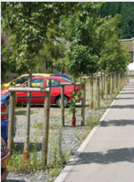
Exemple positif: Parking écologique à Diekirch. Les surfaces de circulation sont exécutées en substrat maigre. L'ordre interne est généré par la disposition des arbres.
