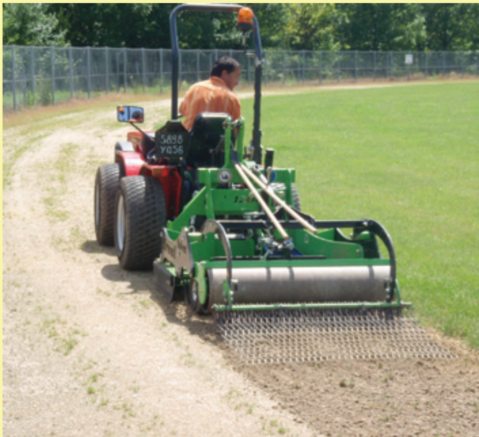
Machine utilisée pour le renouvellement de la couche supérieure des substrats maigres (si nécessaire tous les dix ans).
