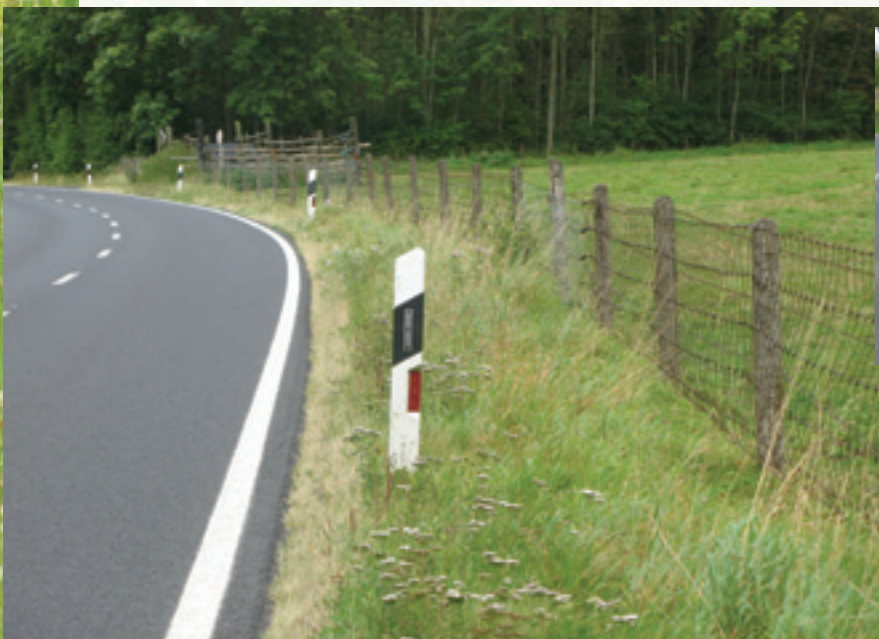
Exemples positifs: Accotements couverts de prairies à herbes courtes en septembre. Ils ont subi une coupe au printemps et, le cas échéant, une deuxième coupe en été. Ils ne devraient plus être fauchés encore une fois en automne. Une telle intervention serait inutile au regard des critères techniques (la visibilité des cataphotes est parfaitement assurée) et contreproductive aux points de vue écologique et paysagers.
